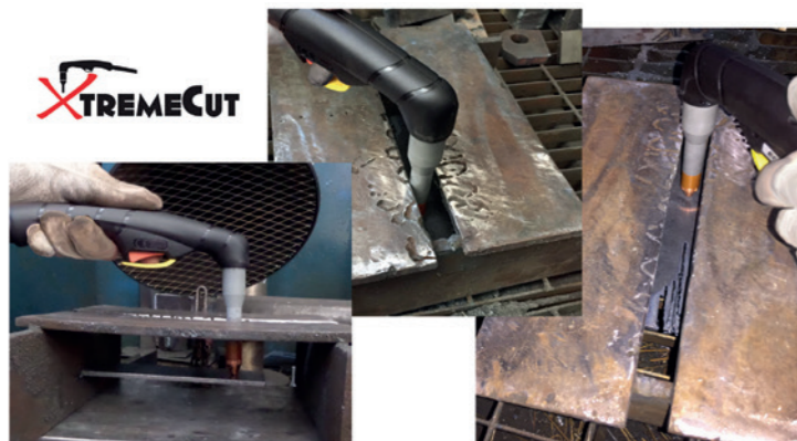
Diese Verschleissteile sind zum Schneiden von normalerweise unzugänglichen Teilen geeignet und aus diesem Grund werden besonders für den Einsatz in metallischen Zimmereien, Abbrucharbeiten und Schiffswerften empfohlen. Sie sind für Handbrenner ECF-71 und ECF-121 (45 und 70 A) erhältlich.
