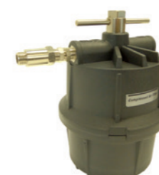
357227 Druckluftfilter, mit Cartridge-Filter zum Schutz der Brenner von Unreinigkeiten der Druckluft (Wasser und/oder Öl). Compressed air filter with filtering cartridge to protect torches against impurities present in compressed air (oil and/or water).
